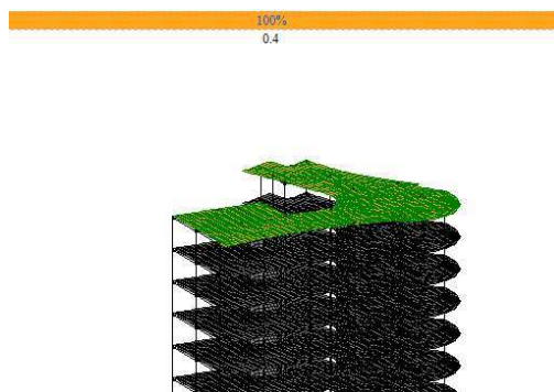
Рисунок 15 - Нагрузки по EN1991 кат. Н
